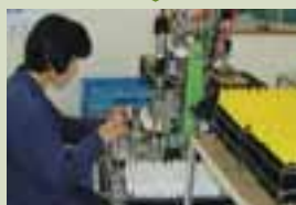
ペイントマーカー インキ再充填作業
